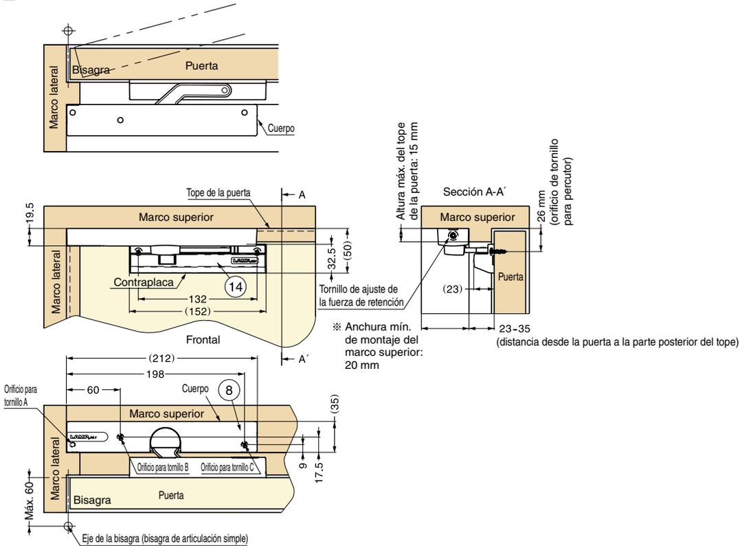
※ Si la distancia entre la puerta y la parte posterior del tope es de 20 mm - 25 mm, usar el orificio para el tornillo A y C
