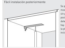
Se puede colocar en mostradores ya existentes sin procesamiento. La posición de instalación se determina fácilmente, solo hay que presionar contra la plantilla de montaje incluida
