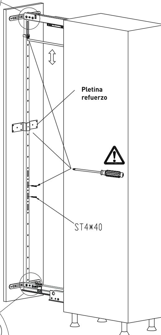
5. Inserta las cestas, tal como se indica en el dibujo. Ajusta el cierre del mueble y, después, aprieta los tornillos.
